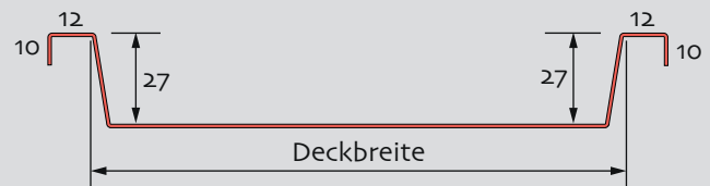
Pass-Schare mit zwei Überdeckungsfalzen
