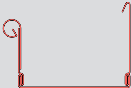
Falzausbildung stehend - stehend mit Aufsteckwulst
