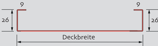
Pass-Schare mit zwei Unterdeckungsfalzen
